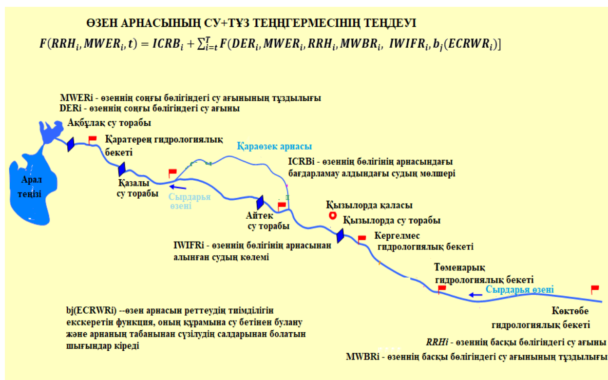
Сурет 2 – Өзен арнасының бөлігінің су – тұз теңгермесінің желілік жүйесі
